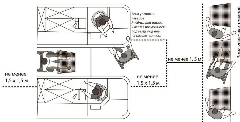
Рисунок 7.20 – Габариты прохода и площадок у кассового аппарата
