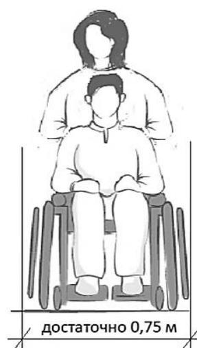
При оказании помощи проезд возможен через дверь шириной 0,8–,9 м
