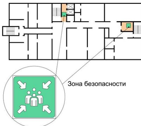
Рисунок 10.29 – Обозначение зоны безопасности на плане здания
