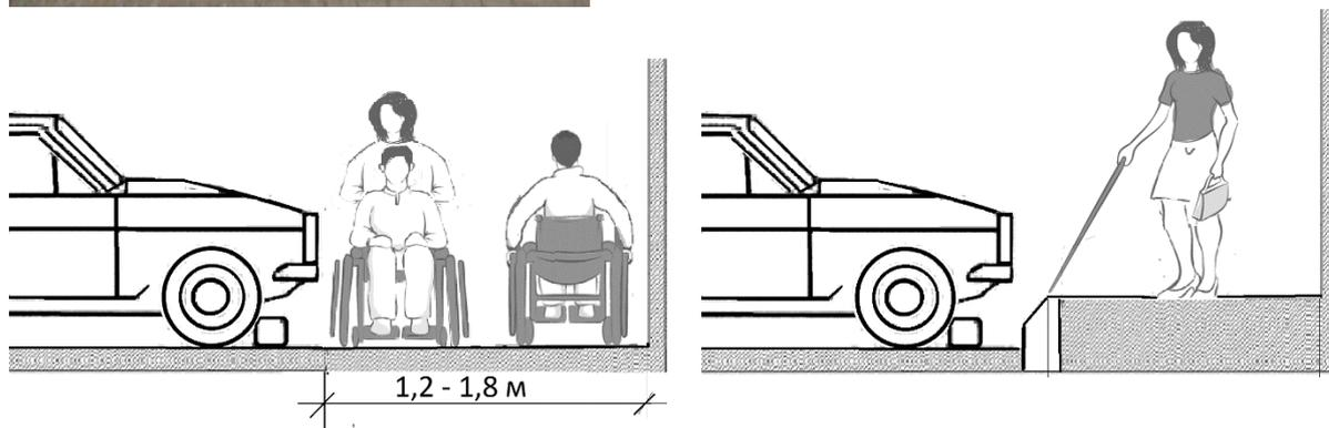
Рисунок 34 – Ограничители парковки вдоль тротуаров для безопасного прохода слепых и достаточной ширины прохода для инвалидов на кресле-коляске
