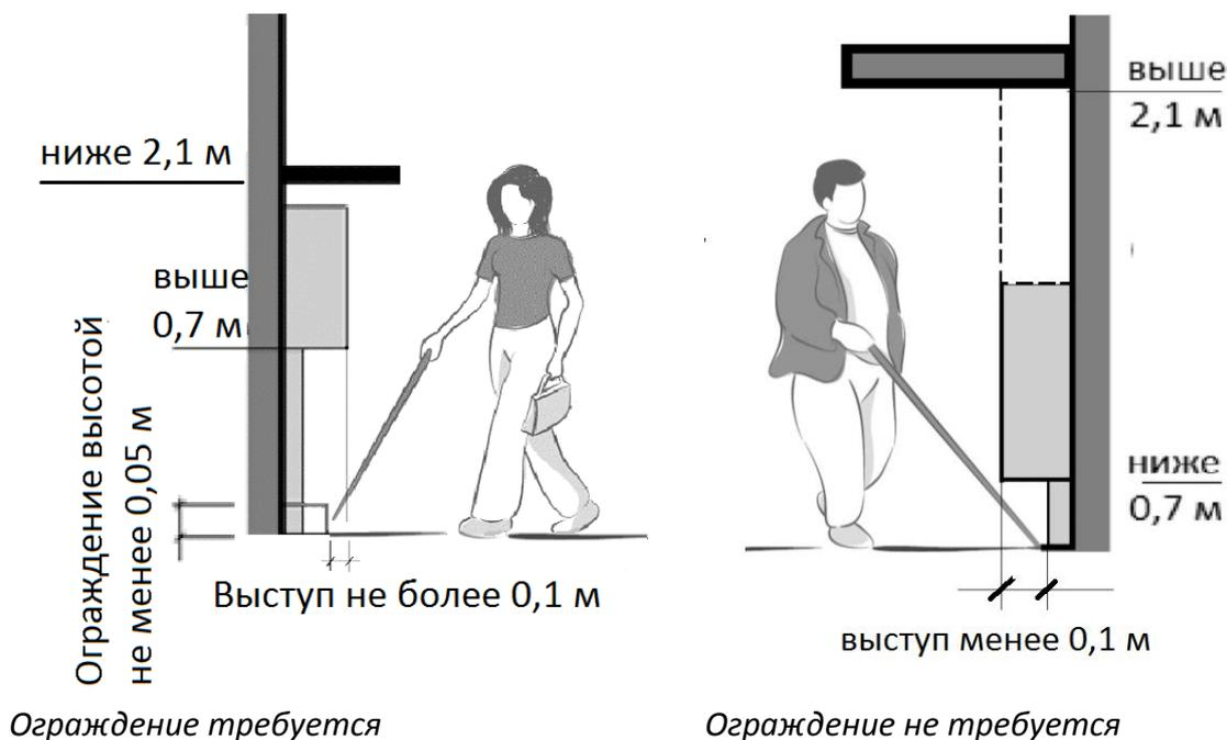
Рисунок 6.76 – Параметры выступающих препятствий
