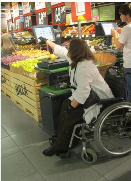
Рисунок 7.10 – Сенсорный экран весового центра расположен слишком высоко. Один из двух рядом расположенных весовых центров можно было бы расположить ниже
