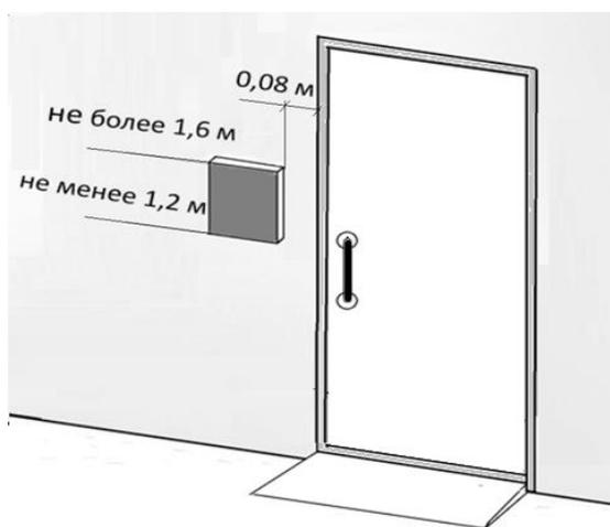
Рисунок 10.9 – Размещение табличек у дверей помещений
