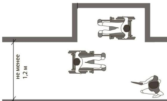
Рисунок 5.5 Устройство разъездных площадок (карманов) на узких тротуарах
