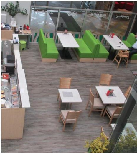
Рисунок 8.4 – Пример сочетания закрепленных сидений у части столов со стульями, которые можно отодвинуть для размещения человека в кресле-коляске
