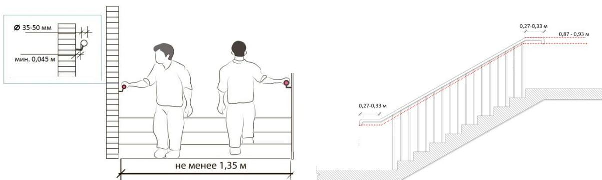
Рисунок 6.83 – Параметры поручней лестницы
