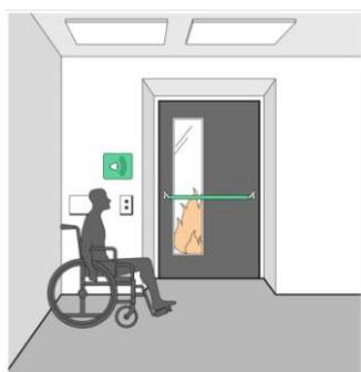
Рисунок 6.101 – Оснащение зоны безопасности переговорным устройством и противопожарными дверями
