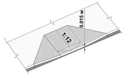
Уклон съезда 12% вблизи здания при затесненных условиях
