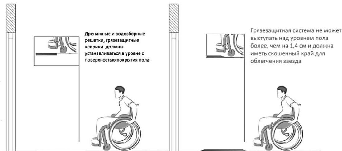
Рисунок 6.56 – Размещение грязезащитных систем
