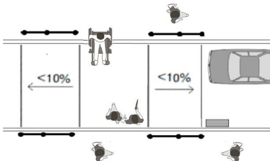
Рисунок 5.15 – Примеры приподнятого перехода через транспортный проезд
