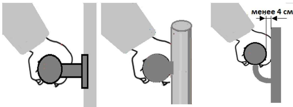
Рисунок 6.19 – Недопустимые варианты крепления поручней
