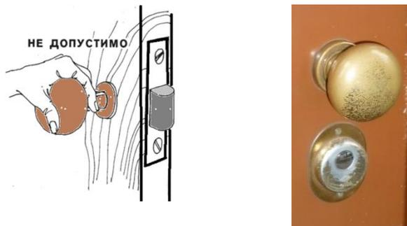
Рисунок 6.60 – Недопустимые конструкции дверных ручек
