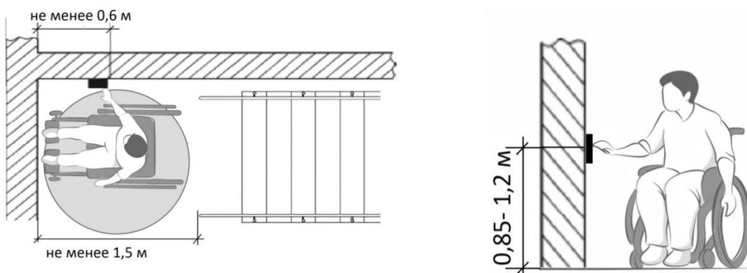
Рисунок 6.12 – Требования к расположению вызывных устройств
