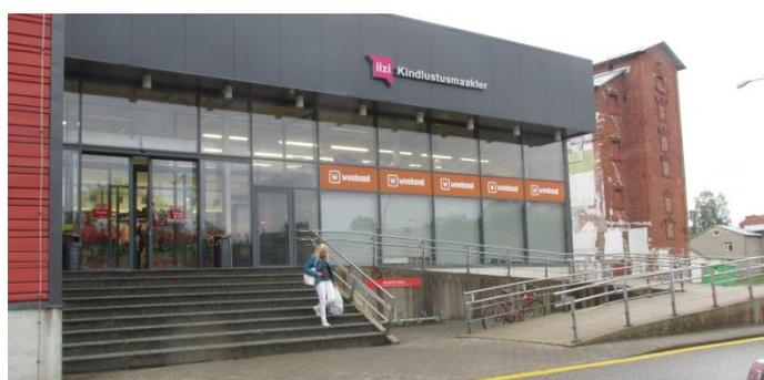
Рисунок 6.27 – При интенсивном движении предпочтительны широкие пологие пандусы, обеспечивающие возможность двустороннего движения
