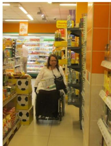
Рисунок 7.3 – Недопустимо сужение проходов за счет временного складирования товаров в ящиках и на паллетах
