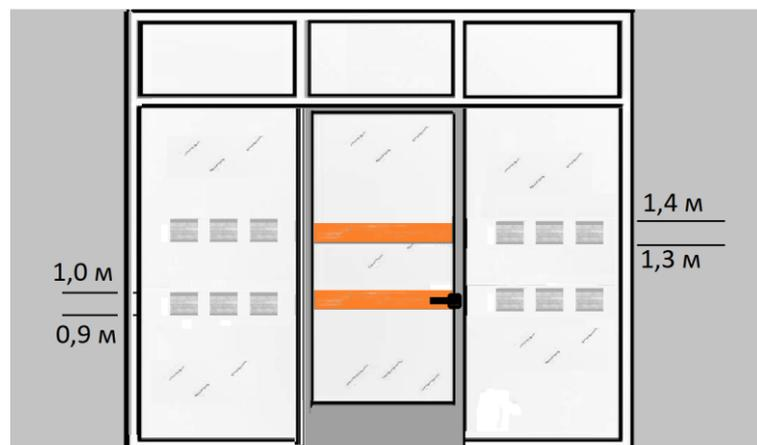
Рисунок 6.63 – Высота размещения контрастной маркировки стеклянных поверхностей
