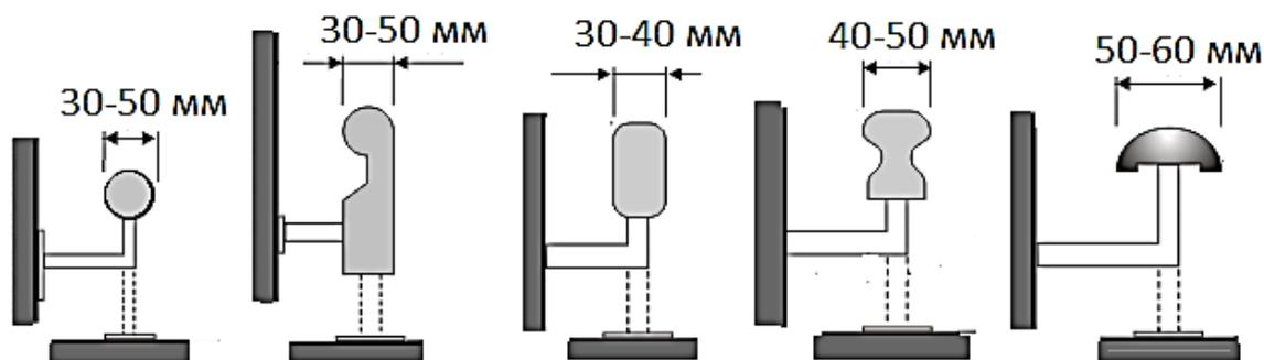
Рисунок 6.19 – Оптимальное сечение поручней в зависимости от конструкции
