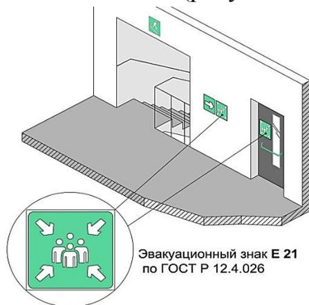
Рисунок 10.28 – Обозначение зоны безопасности
