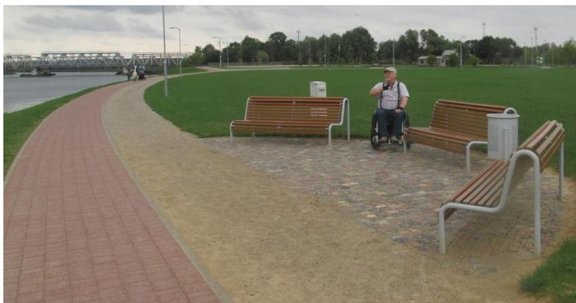
Рисунок 5.37 – Обозначение мест отдыха типом мощения и тактильной полосой
