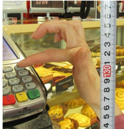
Рисунок 7.21 – Достижимость терминала для оплаты покупок
