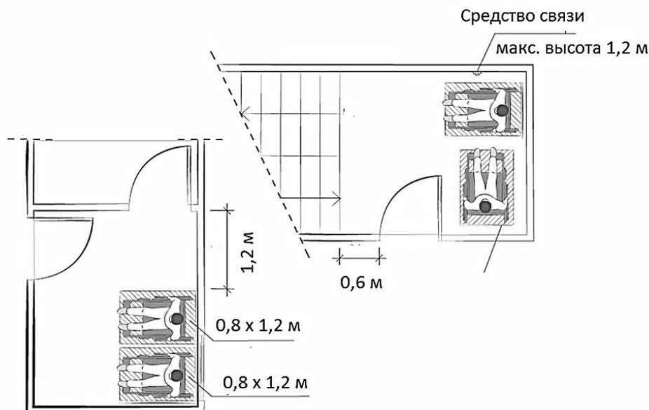
Рисунок 6.99 – Размещение зон безопасности на незадымляемой лестничной клетке
