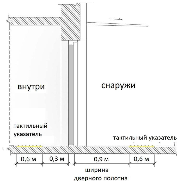
Рисунок 6.65 – Установка тактильных указателей перед дверью
