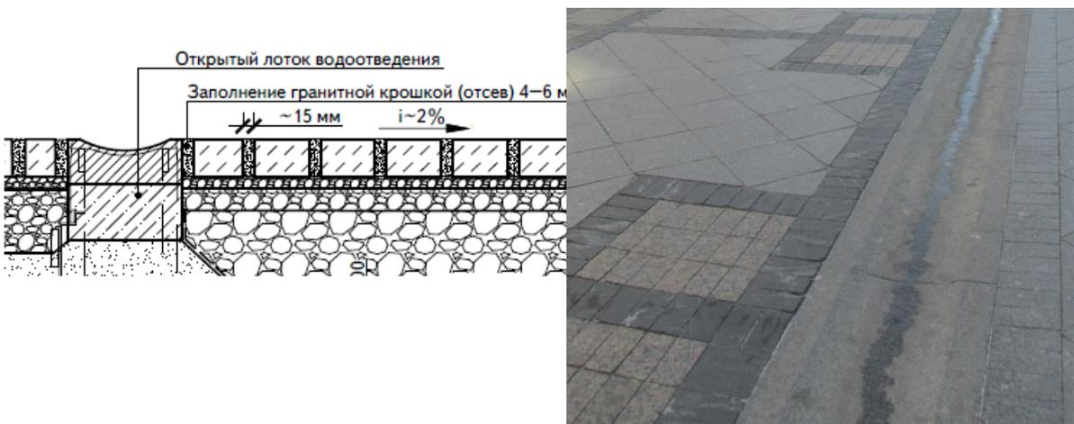
Рисунок 5.25 – Открытые лотки глубиной не более 0,04 м и с пологими краями
