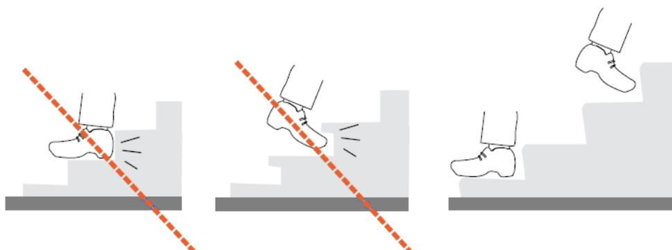
Рисунок 6.82 – Параметры ступеней на путях движения инвалидов
