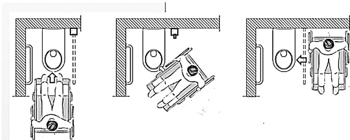
Рисунок 9.2 – Способы пересадки с кресла-коляски на унитаз
