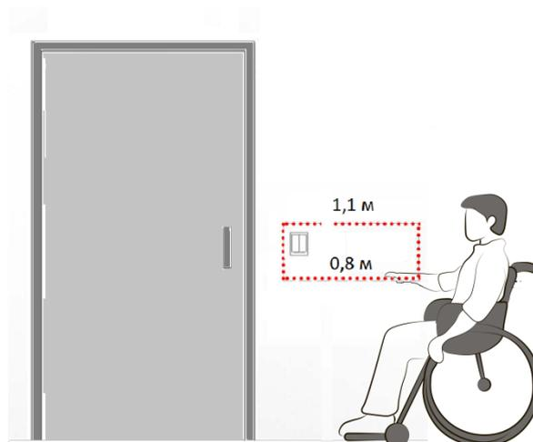
Рисунок 9.9 – Высота расположения выключателей у доступного санузла
