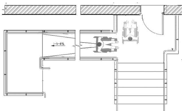
Рисунок 6.35 – Планировочные решения при установке пандусов
