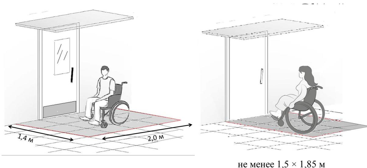
Рисунок 6.2 – Минимальные габариты входной площадки при «нулевом входе».
