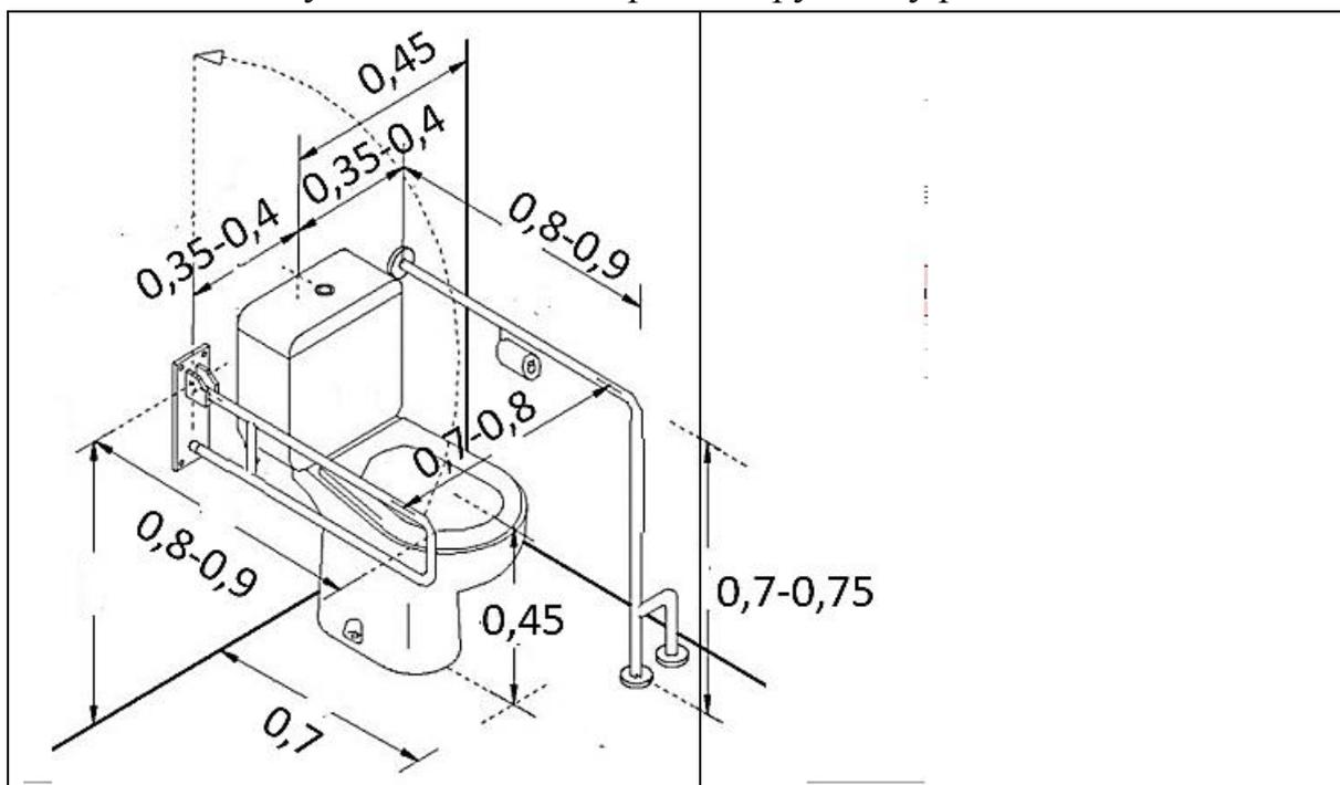
Рисунок 9.6 – Установочные размеры поручней у унитаза
