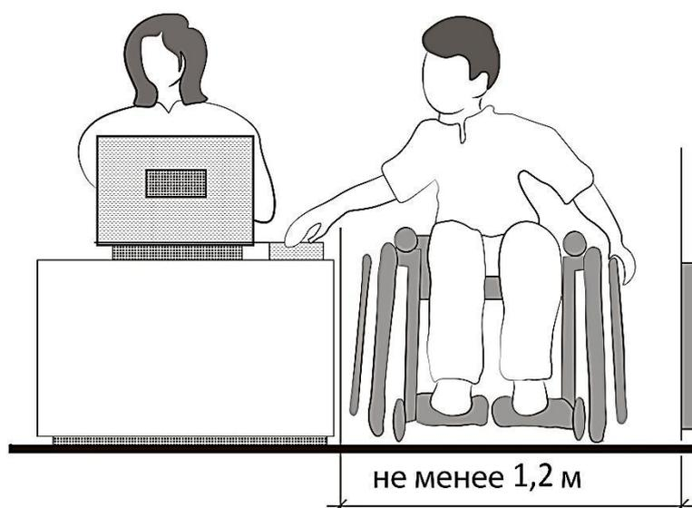
Рисунок 7.14 – Ширина прохода у кассового аппарата
