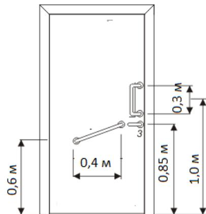
Рисунок 9.10 – Ручка-скоба поперек двери в санузле для облегчения закрывания двери изнутри кабины
